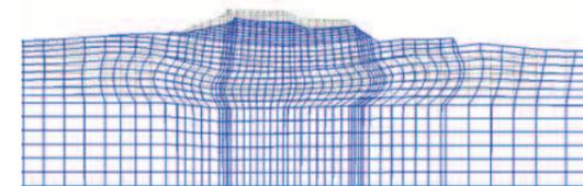
河川堤防の地震時変形解析例
